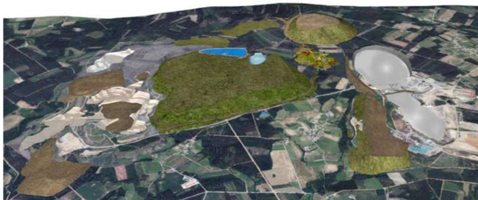
Figura 6. Recreación en 3D na fase 5 (anos 9 e 10) do proxecto: restauración progresiva das labores mineiras en paralelo ás fases extractivas. Fonte: EslA.
